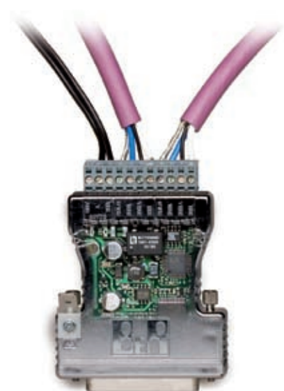
XV – больше, чем а разъем – для гибкой интеграции блоков клапанов
